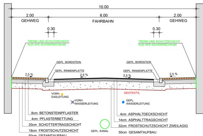
REGELQUERSCHNITT A - A M = 1:50
