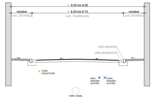
REGELQUERSCHNITT C - C M = 1:50
