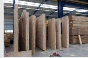
... bis zum fertigen Wandelement
