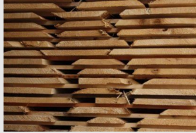
Seitenware – ein Abfallprodukt aus dem Sägewerk ist Grundlage für die Massivholzwand
